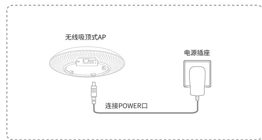
◆ 通电电源后，AP将自动进行初始化，此时系统指示灯先是常亮，初始化完成后，会闪烁2秒，待系统指示灯再次常亮，表示设备已正常工作。指示灯含义说明请参考产品介绍中的系统指示灯含义列表。
